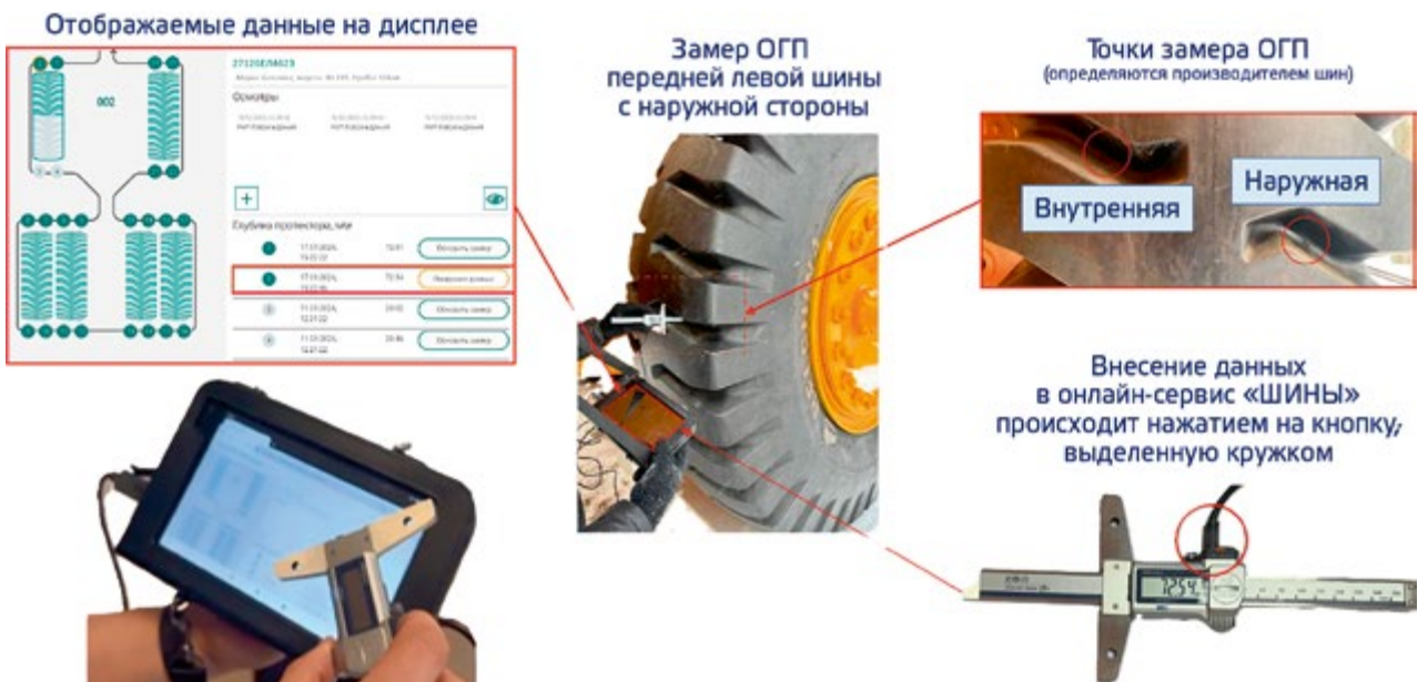
Рис. 3. Пример проведения аудита парка шин в системе онлайн-мониторинга «ШИНЫ»
