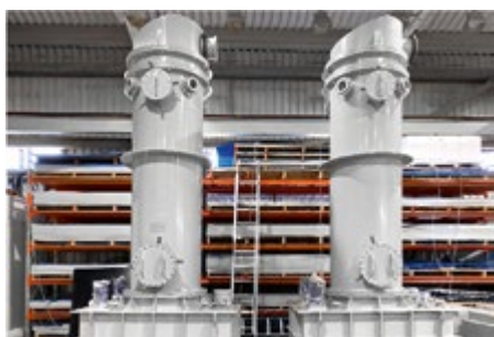
Установки очистки от агрессивных газов
