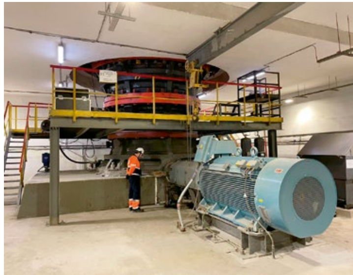
Рис. 9. Привод гирационной дробилки и мельниц
