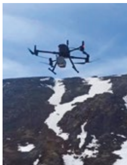
Рис. 1. Квадрокоптер M300 и воздушный лазерный сканер CHCNAV AA10 и AA450
