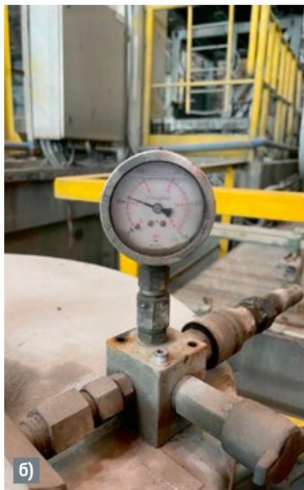
Рис. 8. Снижение давления до (а) и после (б) применения смазочного материала
