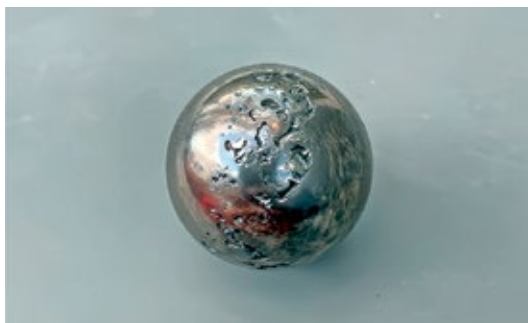
Рис. 2. Разрушение шарика подшипника
