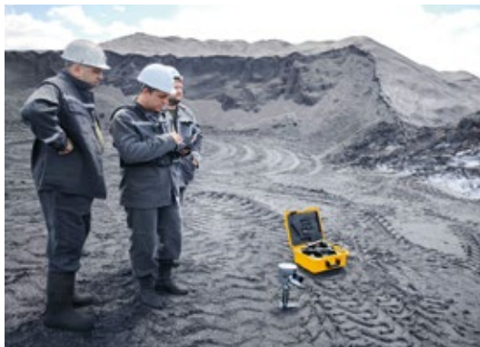
Рис. 2. Съёмка и подсчёт объёмов со сканером CHCNAV RS10
