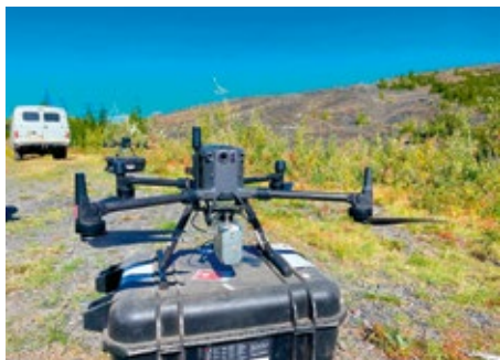
Рис. 1. Квадрокоптер M300 и воздушный лазерный сканер CHCNAV AA10 и AA450
