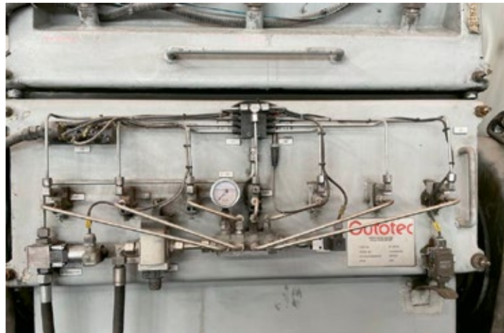
Рис. 6. Система аэрозольной смазки венцовой шестерни мельницы
