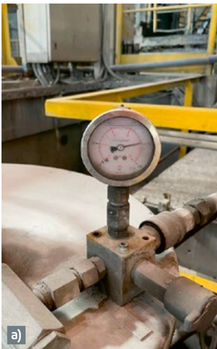
Рис. 8. Снижение давления до (а) и после (б) применения смазочного материала
