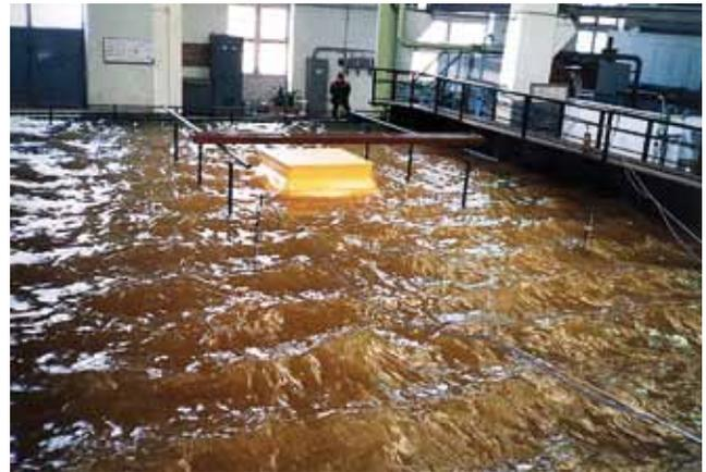
Экспериментальная площадка с моделью платформы Приразломная с защитой от размывов
