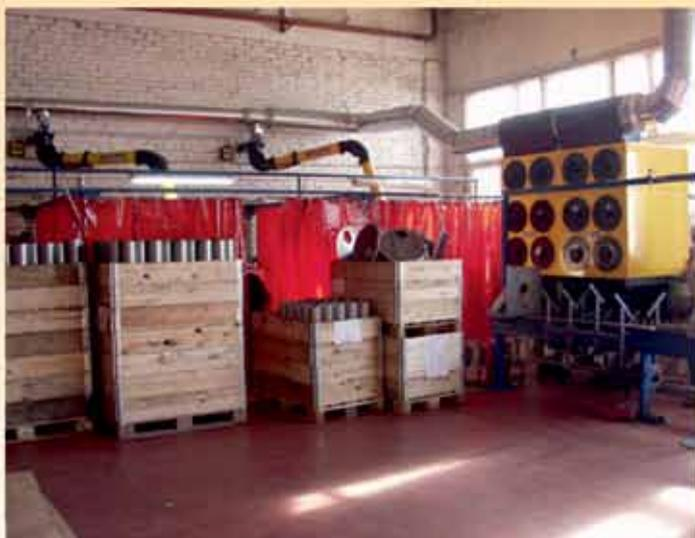
Модульный самоочищающийся кассетный фильтр, соединенный с вытяжными устройствами
