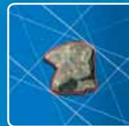
Каждая частица сканируется в 64 направлениях
