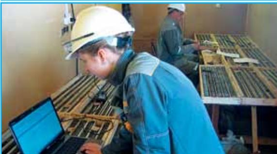
*АГР – автоматизированная система для электронной документации геологоразведочных выработок, хранения и управления геологической информацией. АГР – собственная разработка компании АРДЖЕЙСИ.*
