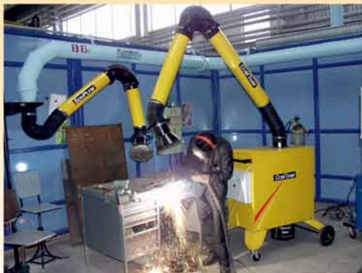
Вытяжное устройство, подключенное к системе вентиляции и очистки воздуха
