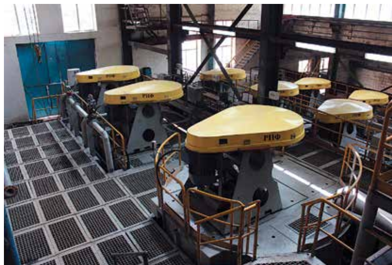
Флотационная секция № 6 Каджаранской обогащательной фабрики, оснащенная флотомашинами РИФ-45
